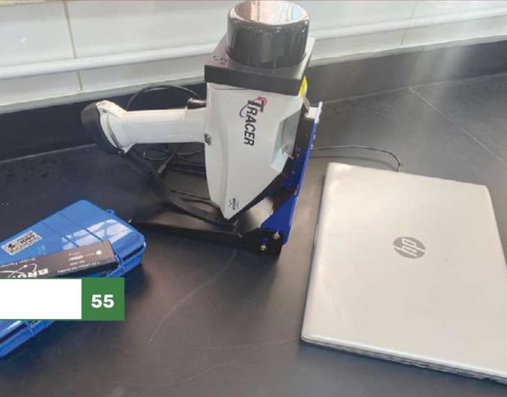
جهاز تحليل الكربون والكبريت (CS-Analyze)، باستخدام طريقة الكشف بالأشعة تحت الحمراء، تتضمن هذه الطريقة التحليلية تحليل العينات الصلبة من خلال حرقها وقياس نواتج الاحتراق (ثاني أكسيد الكربون وثاني أكسيد الكبريت)
