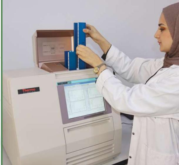
تركيب جهاز مقياس الجرعة الوميضية الحرارية (TLD) في مختبر القياسات الإشعاعية
